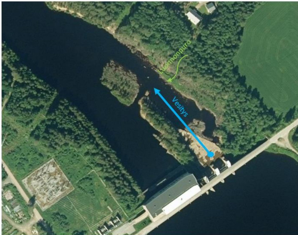
Kuva 24. Esiselvityskohteen kannalta hyväksi vesityskohdaksi arvioitiin juoksutusluukkujen alue. Vesitystarkastelussa huomioitiin myös paikallinen luonnonpuro, joka purkautuu tulvauomaan. Kuva: Paikkatietoikkuna.
