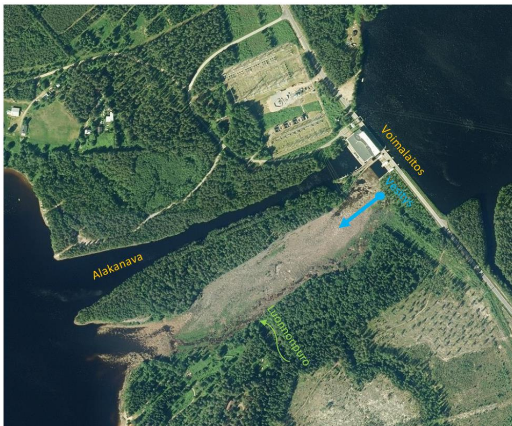
Kuva 59. Nuojuan voimalaitoksen lisääntymisalueen kannalta hyväksi vesityskohdaksi arvioitiin juoksutusluukkujen alue. Vesitystarkastelussa huomioitiin paikallinen luonnonpuro, jota voidaan hyödyntää lisääntymisalueen vesityksessä. Kuva: Paikkatietoikkuna.
